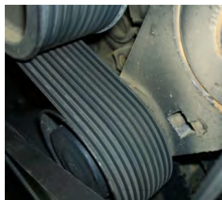
Fig. 13. Den indvendige side af et multibælte. Dette bælte skal være noget strammere end kileremmen.
