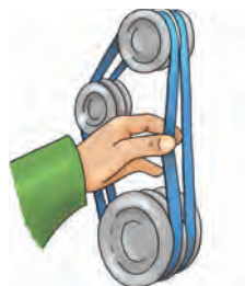
Fig. 12. Kilerem. Remmen skal gerne kunne trykkes cirka 1 centimeter ned mellem remhjulene.
