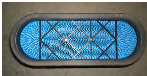
Fig. 7. Ovalt luftfilter tæt på. Et filter som det her viste må ikke rengøres, kun bankes forsigtigt mod hånden.
