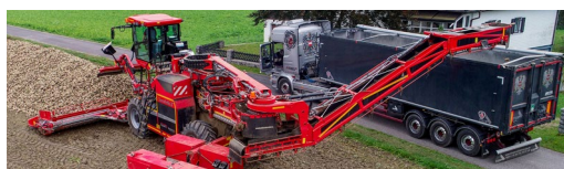
1.2. Oversize motorredskaber kan fra 1/6-2023 køre som selvkørende blokvogn. Nogle motorredskaber er 15 m lange, fordi det tillades i bl.a. Tyskland. Derved overskrides de 12 m, der er gældende i Danmark. Specielt kartoffel- og roeoptagere, samt rense-læsemaskiner er berørt. Særtransportbekendtgørelsen indeholder nu begrebet "stort motorredskab", så der kan søges tilladelse til oversize motorredskaber inklusiv motorredskaber med bæltter. Læs mere på LandbrugsInfo.
