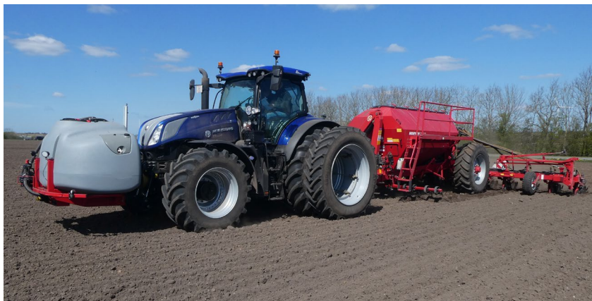
1.8 Teleskopisk spejle, hvor længden kan indstilles, sikrer, at man kan se forbi brede redskaber.
