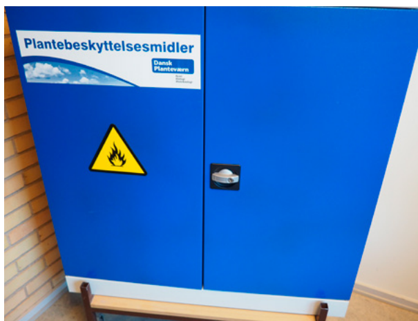
Sprøjteskab med lås, skilt og opsamlingsbakke.
