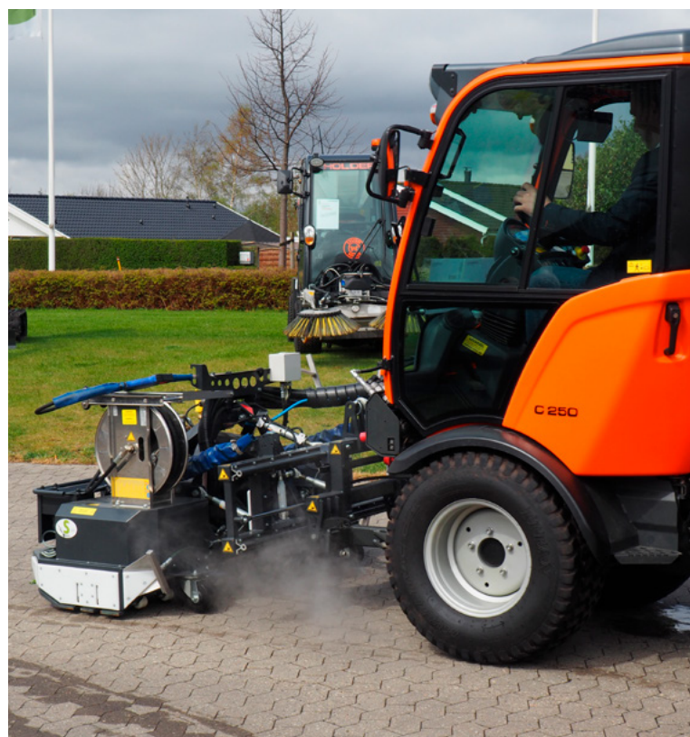
Ukrudtsbekæmpelse med damp.
