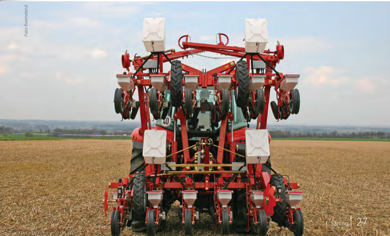
1.27. 6 meters 12-rækket roesåmaskine med parallelhydraulisk foldning til transportstilling.
