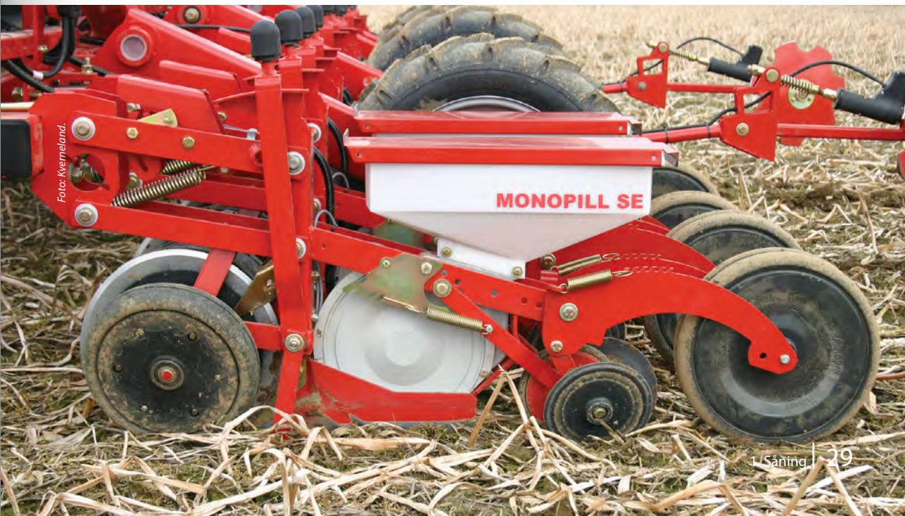
1.29. Såaggregat med parallelogram-ophæng og bærehjul i begge ender til at fastholde sådybden nøjagtigt.
