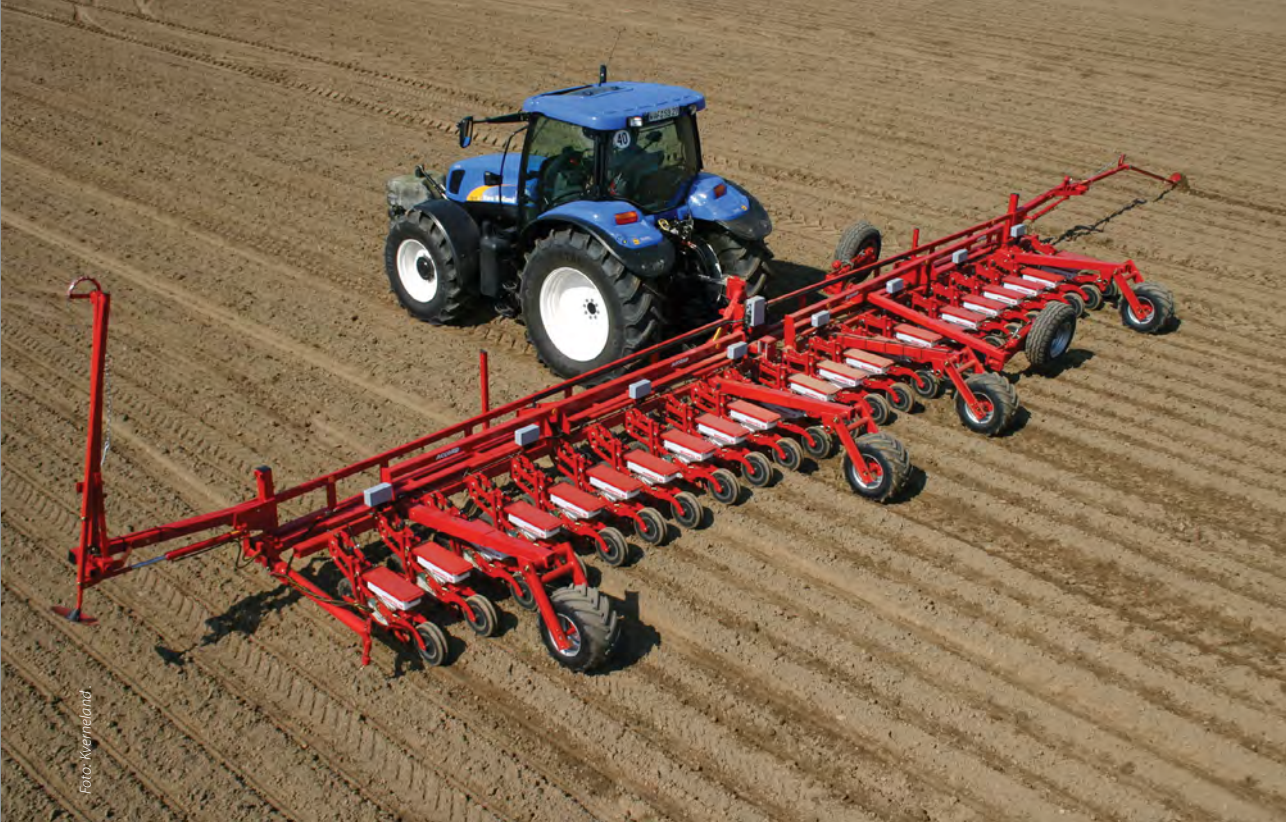
1.26. 12 meter 24-rækket roesåmaskine med cellehjulsmaskine i arbejdsstilling.
