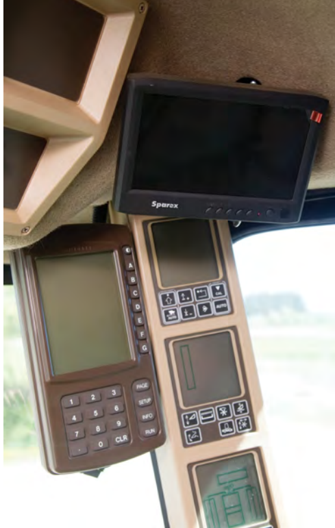
6.46. Nye og nyere mejetærskere er udstyret med elektronisk overvågning af maskinens vigtigste funktioner.
