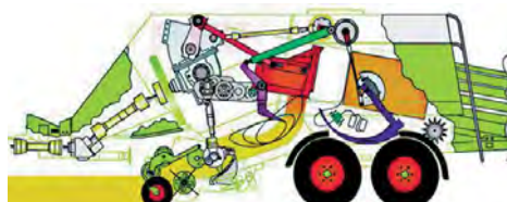
7.11. Principskitse af transmissionen i en mini-ballepresser med kardantræk.
