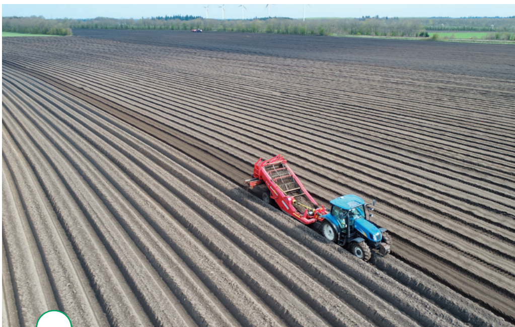
Stenstrenglængning fjerner stenene og giver løs jord, som hurtigt opvarmes.
