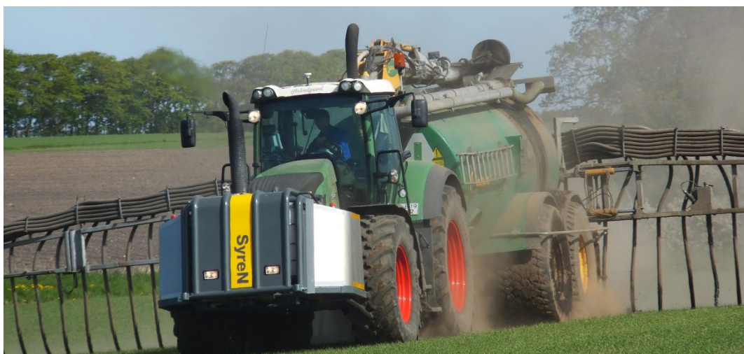
3.5 Gyllevogntog med Syren-udstyr. Svovlsyren medbringes i det kollisionssikrede sikkerhedsbur i front.
